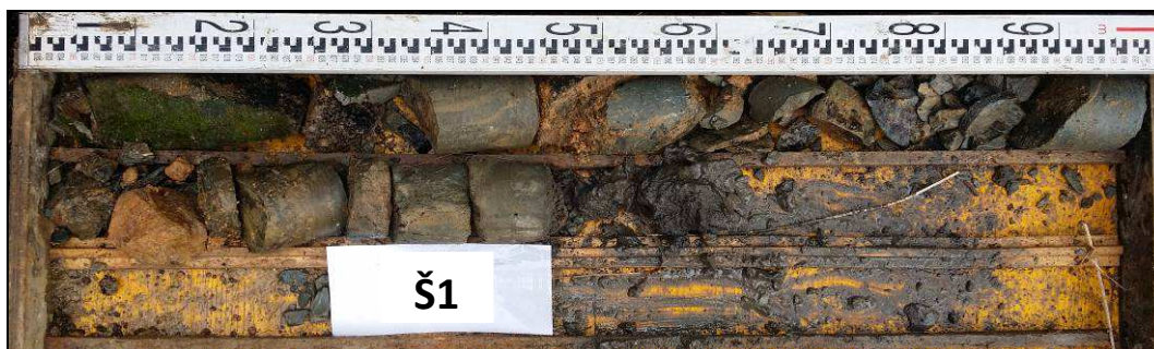
Obr. č. 2 - diagnostický vrt Š1 - pod úroveň základové spáry opěry Troubelice
